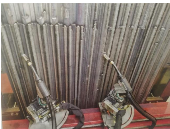
Рис. 6. Наплавка газоплотных панелей с СМТ-переносом.
