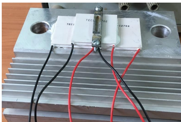
Рис. 5. Внешний вид системы элементов Пельтье с активным охлаждением.
