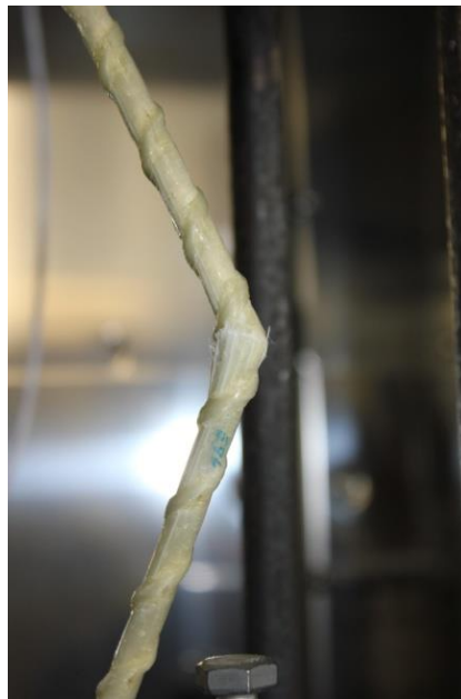
Рис. 2. Характер разрушения арматуры.
