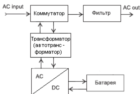
Рис. 2. Структурная схема ИБП типа line-interactive.
