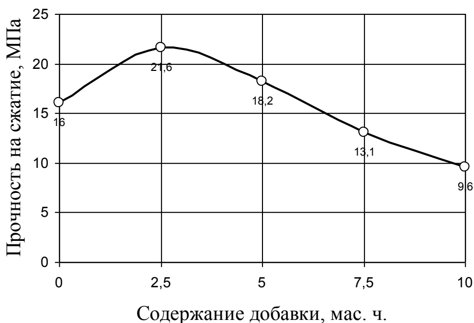
Рис. 1. Изменение предела прочности на сжатие композитов на основе цемента М400 Д0 от количественного содержания натрия сернокислого
