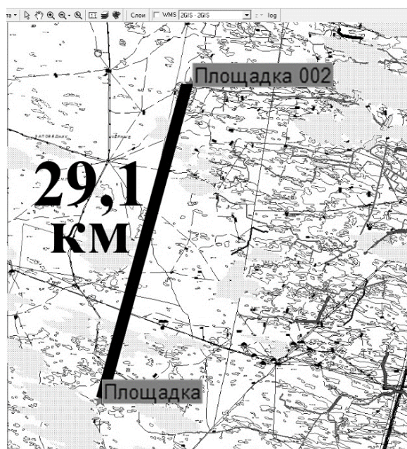
Рис. 3. Моделируемый в ONEPLAN RPLS-DB Link радиорелейный интервал.
