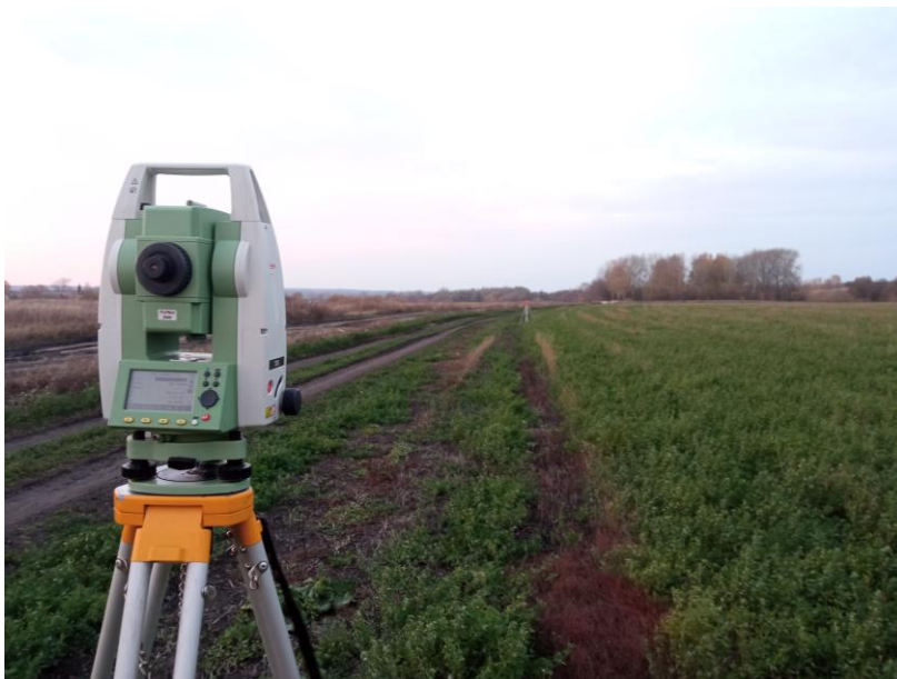
Рис. 1. Тахеометр Leica TS02 в рабочем положении.
