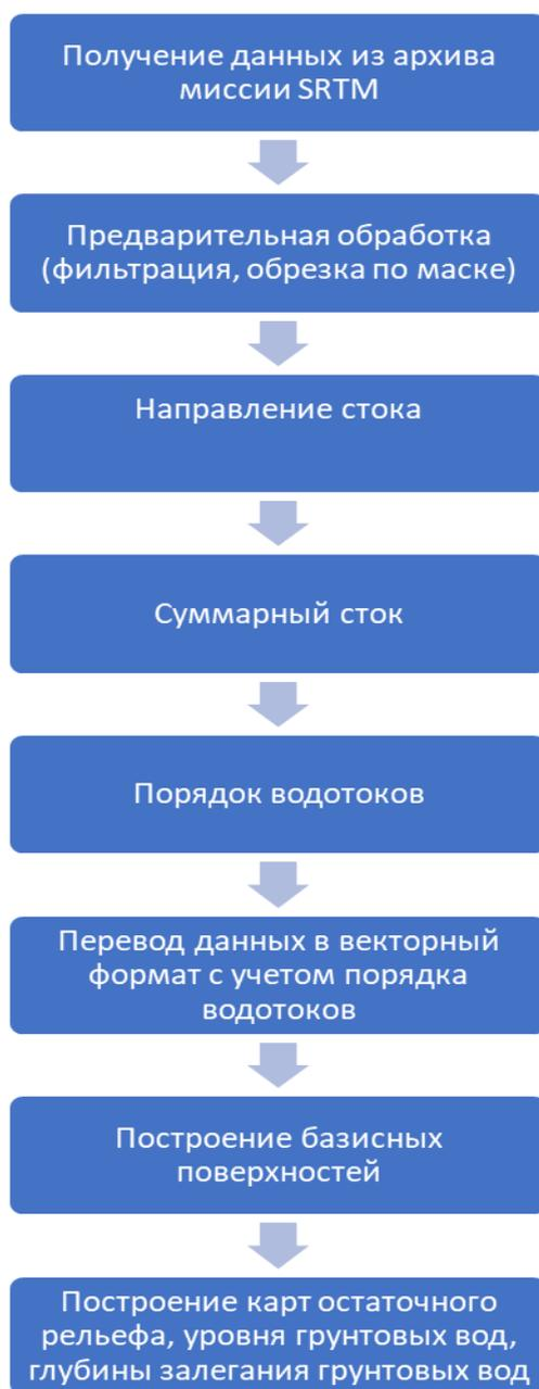
Рис. 1. Схема обработки данных в ГИС ArcGIS.
