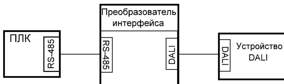
Рис.1. Общая структурная схема включения преобразователя интерфейсов.
