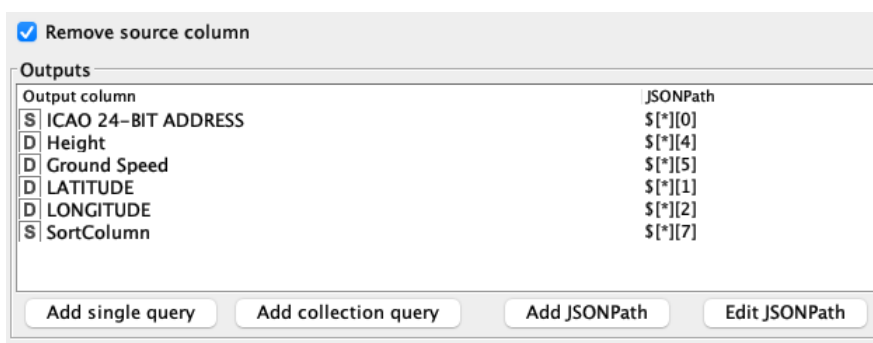
Рис. 5. Фрагмент окна настроек узла JSON Path.
