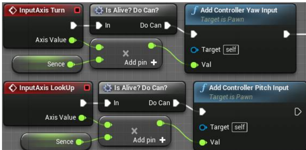
Рис. 3. Модуль логики управления камерой.
