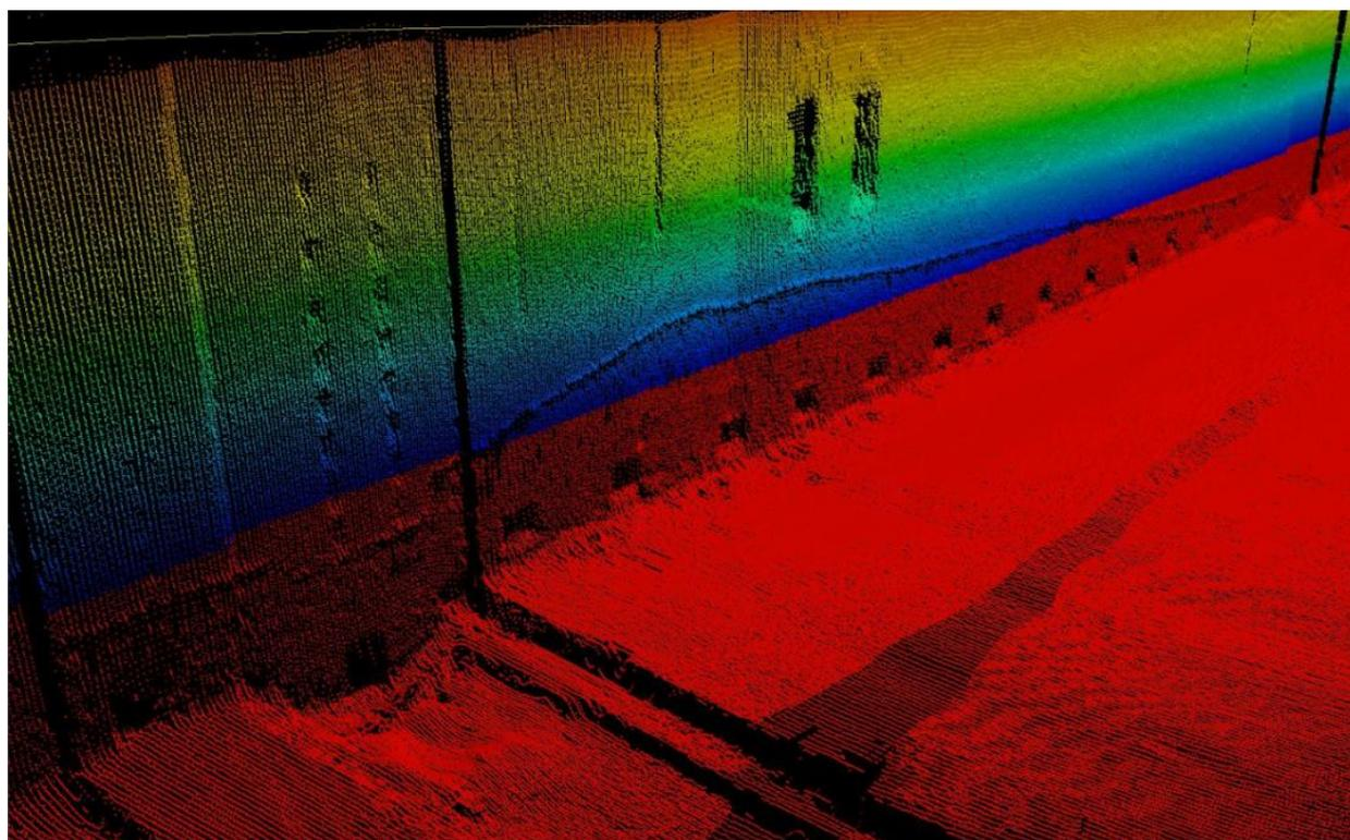
Рис. 1. Пример цифровой модели рельефа участка дна водоема, полученной по результатам площадной съемки многолучевым эхолотом [1].
