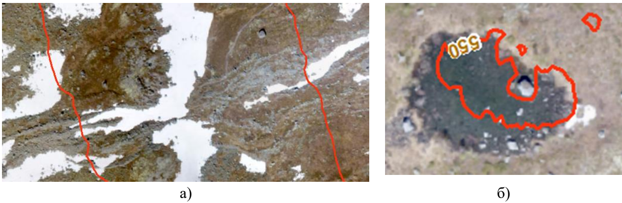
Рис. 3. Ошибки автоматизированной прорисовки горизонталей.
