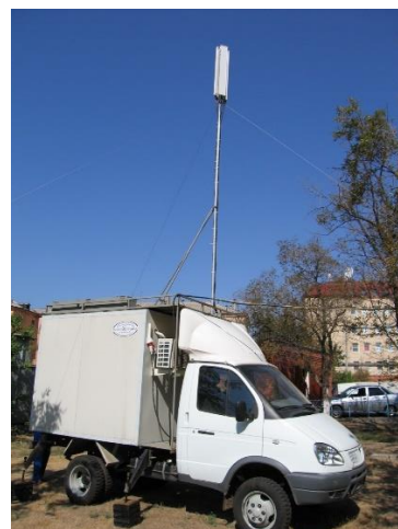
Рис. 2. Мобильная станция как средство замены временно вышедших из строя базовых станций
