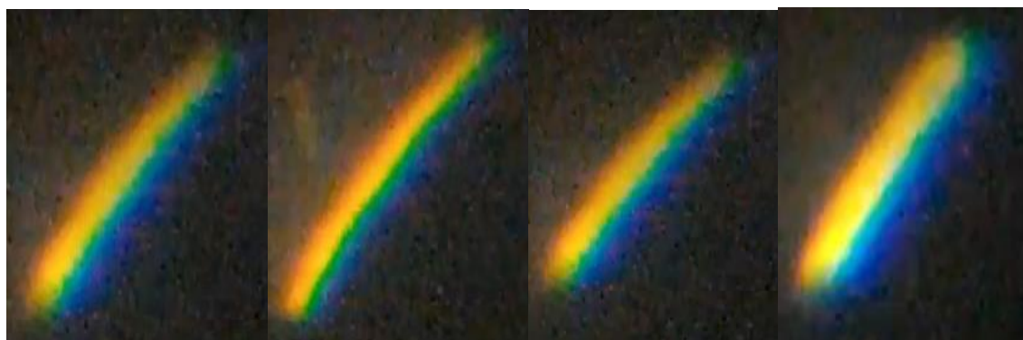
Рис. 8. Фото фиксация спектров вспышки плазмы по времени воздействия на воду
