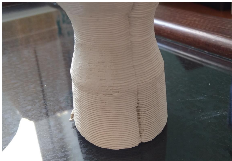
Рис. 1. Шов на изделии по линии перехода печатающей головки на новый слой
