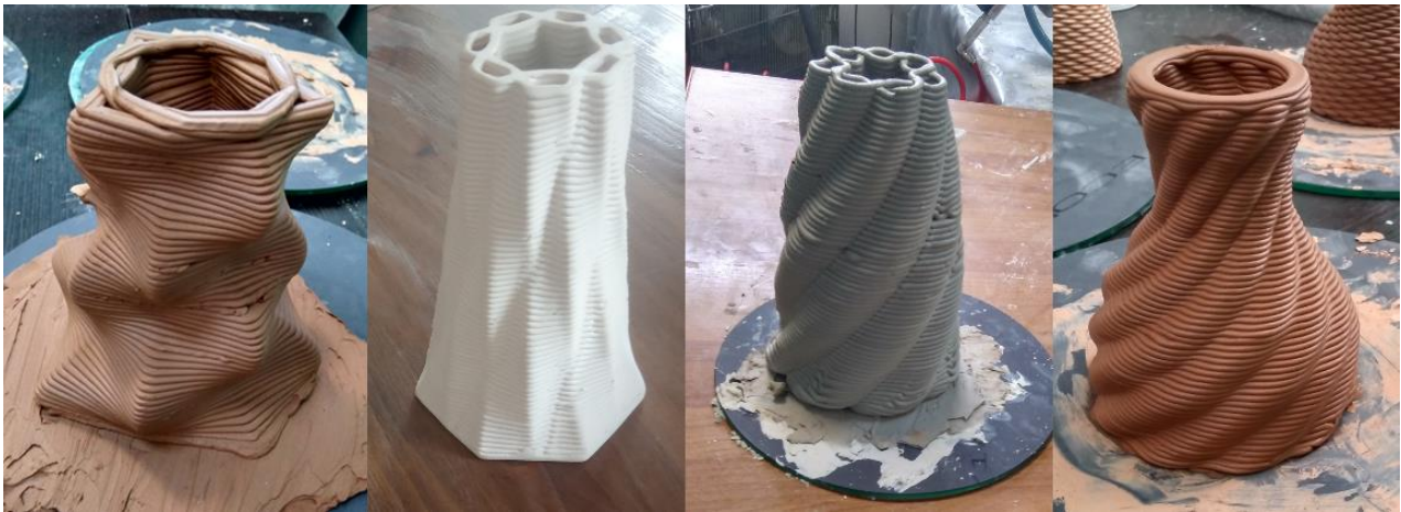
Рис. 5. Изделия, сформированные при разных настройках параметров алгоритма.
