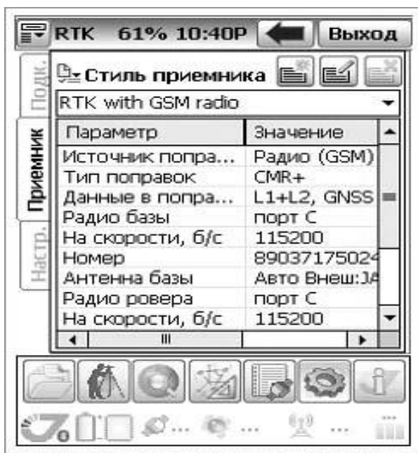
Рис. 2. Настройка контроллера JAVAD Victor на RTK-режим.
