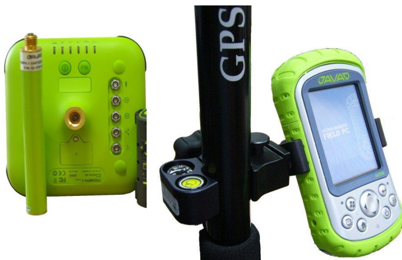
Рис. 1. Комплект оборудования для проведения GPS-съемки с использованием RTK-режима.
